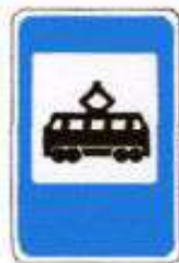
5.13.1 Остановочный пункт трамвая
